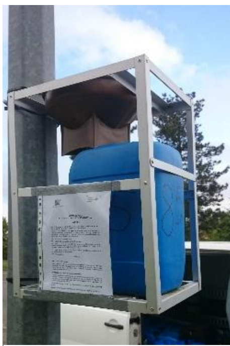
Photographie exemple des jauges Owen utilisées durant les campagnes d'hiver pour la mesure des retombées totales. Les jauges en verre sont indispensables pour la mesure des dioxines et furanes.
