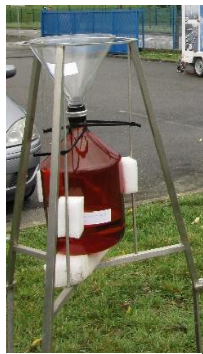
Photographie exemple des jauges Owen utilisées durant les campagnes d'hiver pour la mesure des retombées totales. Les jauges en verre sont indispensables pour la mesure des dioxines et furanes.
