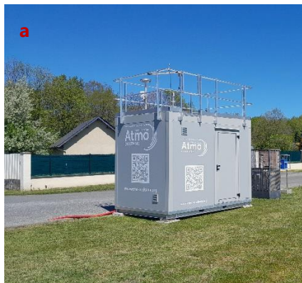
Station de mesure renfermant les analyseurs installés sur le site d'Escala (a), exemple d'analyseurs automatiques utilisés pour le NO 2 et PM 10 /PM 2,5 et pour la mesure des métaux (c).
