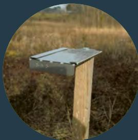
**Les plaquettes de dépôts** sont des plaquettes métalliques enduites d'un fixateur. Ce type de dispositif permet de récupérer par gravité les retombées atmosphériques sèches : matières particulaires transportées par l'air.
