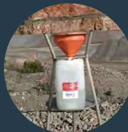
**Les jauges** sont constituées d'un récipient de collecte et d'un entonnoir. Ce dispositif permet de collecter les retombées atmosphériques totales qui se composent des retombées sèches et des retombées contenues dans les eaux pluviales.
