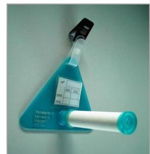
Figure 2 : Capteur passif de benzène
