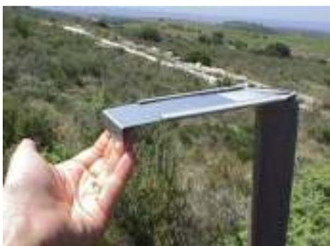
Les poussières sédimentables se déposent sur une plaquette métallique de surface connue (50 cm<sup>2</sup>), enduite d'un fixateur et installée horizontalement à 1,5 m de haut (voir photo ci-contre)
