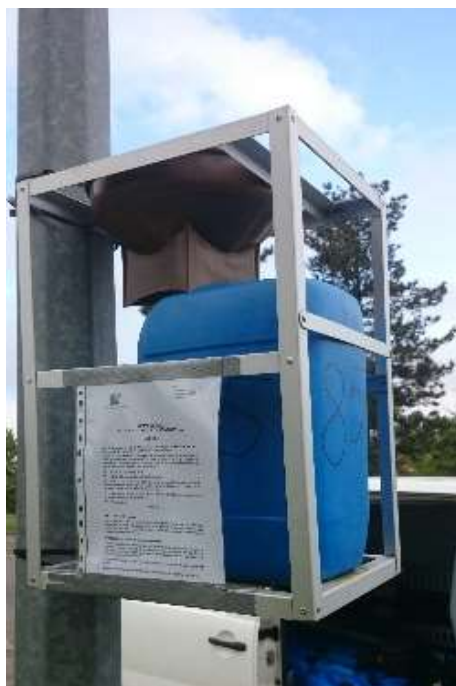
Photographie des jauges Owen utilisées durant les campagnes d'hiver pour la mesure des retombées totales. Les jauges en verres sont indispensables pour la mesure des dioxines et furanes.
