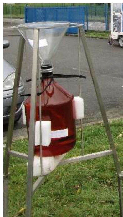
Photographie des jauges Owen utilisées durant les campagnes d'hiver pour la mesure des retombées totales. Les jauges en verres sont indispensables pour la mesure des dioxines et furanes.
