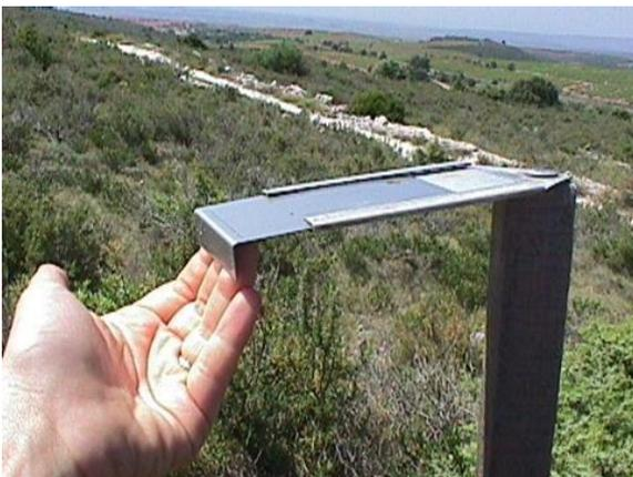
Les retombées atmosphériques sèches se déposent sur une plaquette métallique enduite d'un fixateur, de dimension 5cm x 10cm, installée horizontalement à 1,5 m de haut.
