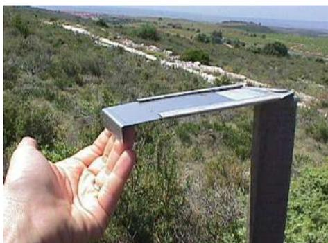
Les poussières sédimentables se déposent sur une plaquette métallique de surface connue (50 cm<sup>2</sup>), enduite d'un fixateur et installée horizontalement à 1,5 m de haut (voir photo ci-contre). Les mesures se font dans un environnement dégagé, permettant la libre circulation des poussières autour du dispositif.
