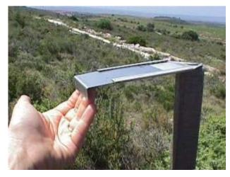
Les retombées atmosphériques sèches se déposent sur une plaquette métallique enduite d'un fixateur, de dimension 5cm x 10cm, installée horizontalement à 1,5 m de haut (voir photo ci-dessus).
