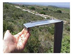
Les poussières sédimentables se déposent sur une plaquette métallique de surface connue (50 cm²), enduite d'un fixateur et installée horizontalement à 1,5 m de haut (voir photo ci-contre)
