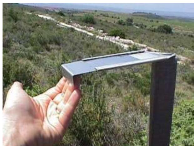
Les retombées atmosphériques sèches se déposent sur une plaquette métallique enduite d'un fixateur, de dimension 5cm x 10cm, installée horizontalement à 1,5 m de haut (voir photo ci-dessus).
