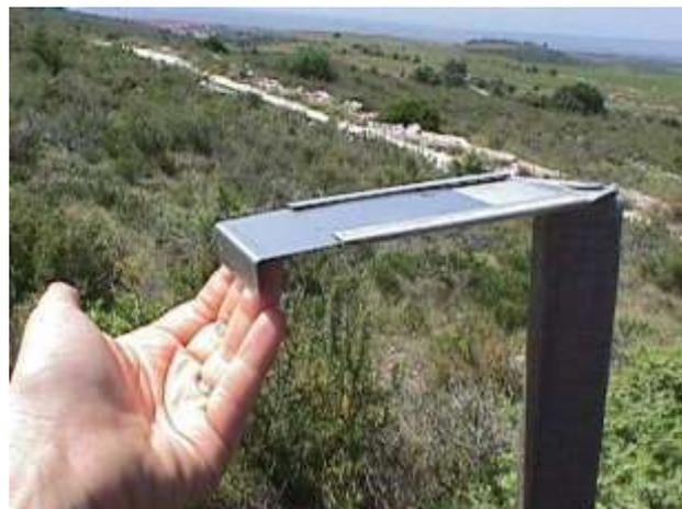
Les retombées atmosphériques sèches se déposent sur une plaquette métallique enduite d'un fixateur, de dimension 5cm x 10cm, installée horizontalement à 1,5 m de haut (voir photo ci-dessus). Chaque plaquette est repérée par un numéro et possède une surface utile d'exposition de 50cm<sup>2</sup>.
