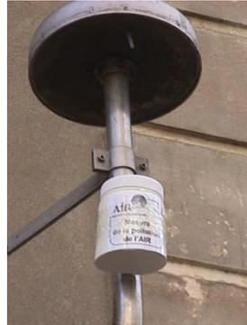
Après cette période d'exposition, le dioxyde d'azote est analysé a posteriori par un dosage colorimétrique qui permet de connaître la concentration du NO<sub>2</sub> dans l'air ambiant. La préparation, la pose, le ramassage puis l'analyse des tubes sont réalisés par Atmo Occitanie.
