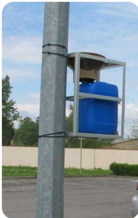
Le collecteur de précipitation est un récipient d'une capacité suffisante (25 litres) pour recueillir les précipitations de la période considérée et est muni d'un entonnoir de diamètre connu (29 cm de diamètre). Le dispositif est placé à une hauteur comprise entre 1,5 mètre et 3 mètres. La durée d'exposition du collecteur est d'environ 2 mois. Le récipient est ensuite envoyé en laboratoire pour analyse.
