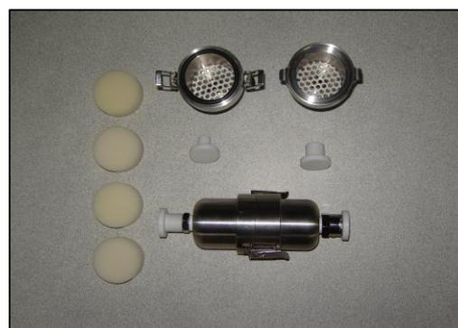
Cartouche de prélèvement et mousses PUF utilisées pour le prélèvement
