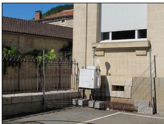
Préleveur de particules PM<sub>10</sub> – Station de mesure
