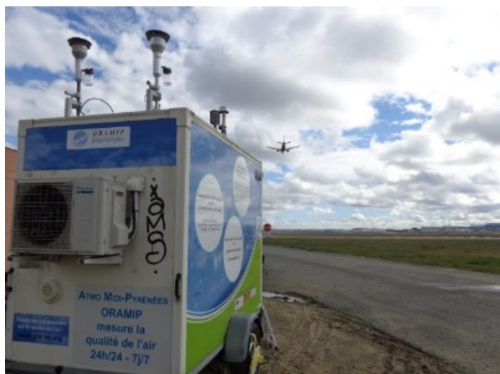
Photographie 1 : station provisoire implantée à proximité des pistes
