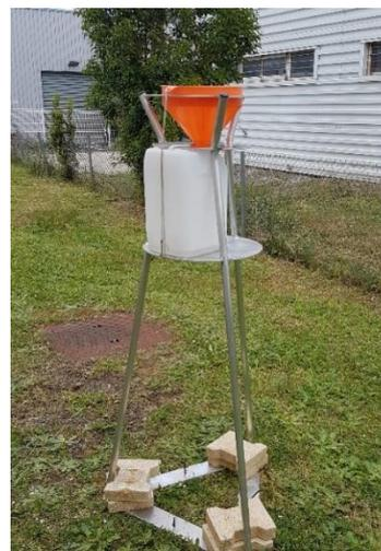
Les plaquettes qui étaient jusqu'à présent utilisées pour la mesure des poussières sédimentables sont remplacées par des jauges de 10 L maintenus par un trépied.
