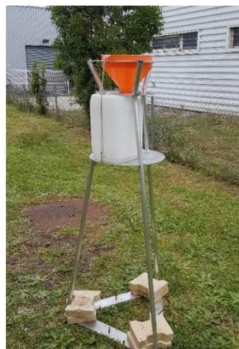
Les plaquettes qui étaient jusqu'à présent utilisées pour la mesure des poussières sédimentables sont remplacées par des jauges de 10 L maintenus par un trépied.
