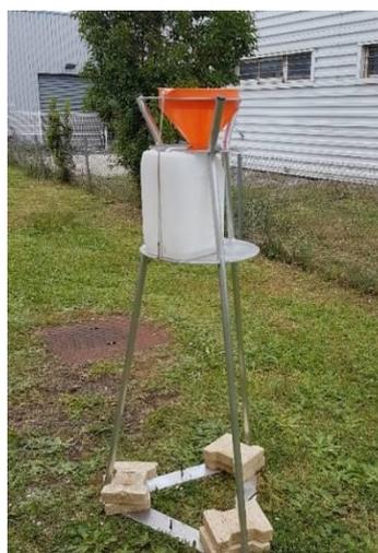
Les plaquettes qui étaient jusqu'à présent utilisées pour la mesure des poussières sédimentables sont remplacées par des jauges de 10 L maintenues par un trépied.
