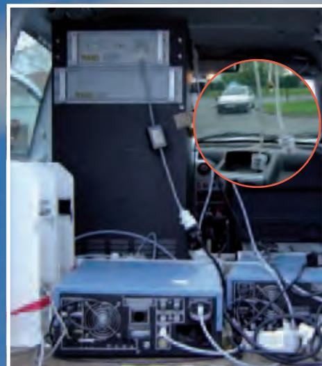
Véhicule équipé de capteurs de particules fines et d'analyseurs de gaz
