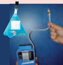
Pompe manuelle et tube de prélèvement d'air
