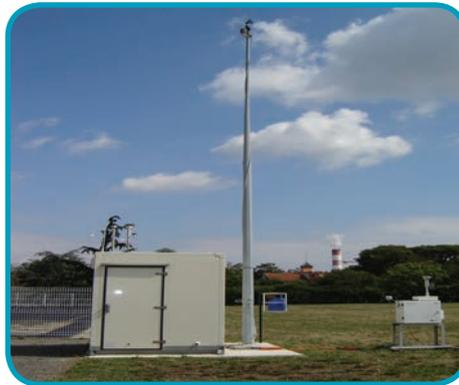
Les analyseurs sont installés dans des cabines de mesures sous les deux directions de vents dominants.
